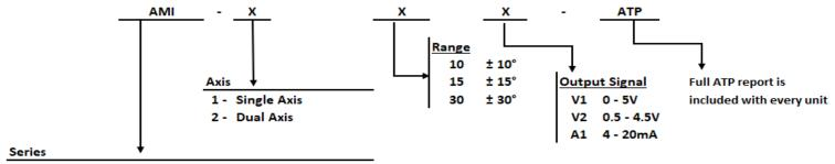
AMI - Analog MEMS Inclinometer
