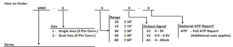
AMH - Analog MEMS Inclinometer
